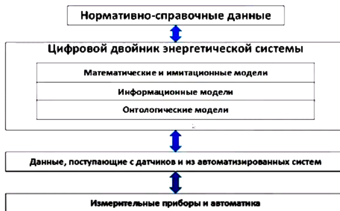
Рис.2. Структура цифрового двойника энергетической системы Fig. 2. Structure of the digital twin of the energy system
