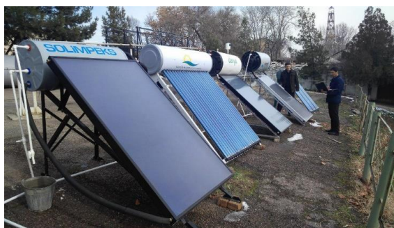
Рис. 2. Оборудование экспериментальных исследований, проводимых в натурных условиях на Гелиополигоне по определению тепловой эффективности СВУ ФТИ АН РУз (2017-2021 гг.)
