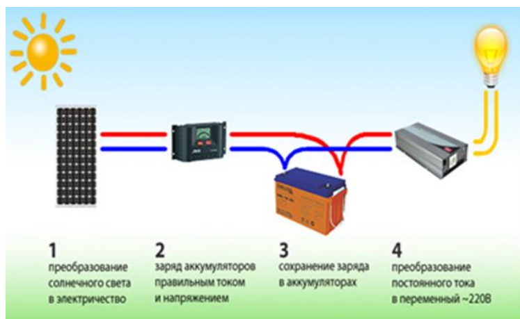
Рис.11. Блок схема ИБП: солнечная батарея - контроллер - АБ - инвертор
