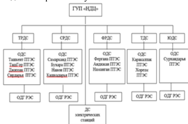
Рис.2. Структурная схема пространственной иерархии органов оперативно-диспетчерского управления ЭЭС Узбекистана: ГУП «НДЦ» – Государственное унитарное предприятие «Национальный диспетчерский центр»
