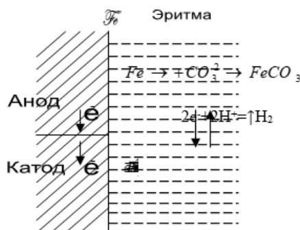
1-расм. Иссиқлик таъминоти қувурларининг CO_2 гази таъсирида занглаш механизми
