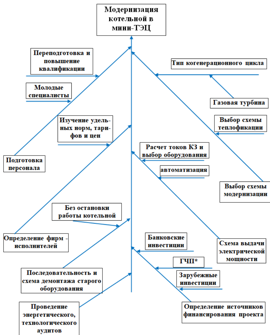
Рис.4. Пример диаграммы Исикавы для решения общей задачи модернизации котельной в мини-ТЭЦ; (*ГЧП – государственно-частное партнерство)
