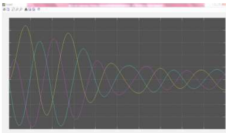
4–расм. Асинхрон моторнинг ишга тушиш даврида статор чулғамларидан ўтаётган ток кучларининг вақт бўйича ўзгариш графиклари
