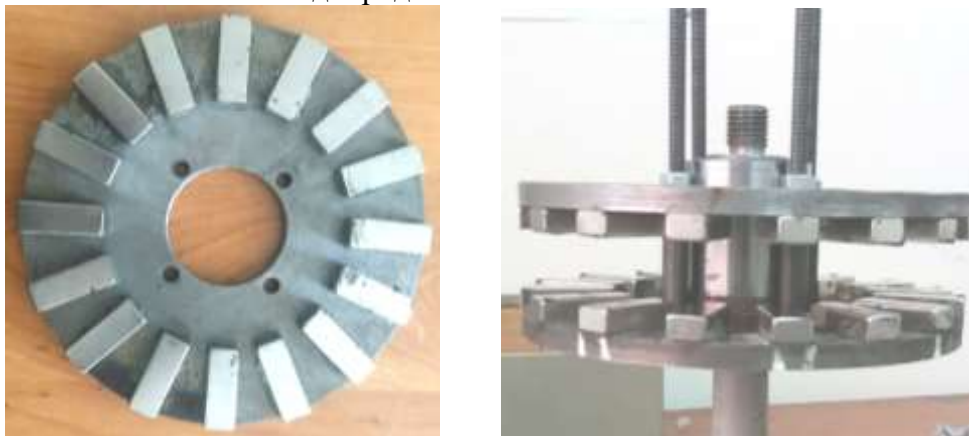
Рис. 9. Процесс работы по изготовлению ротора электрогенератора
