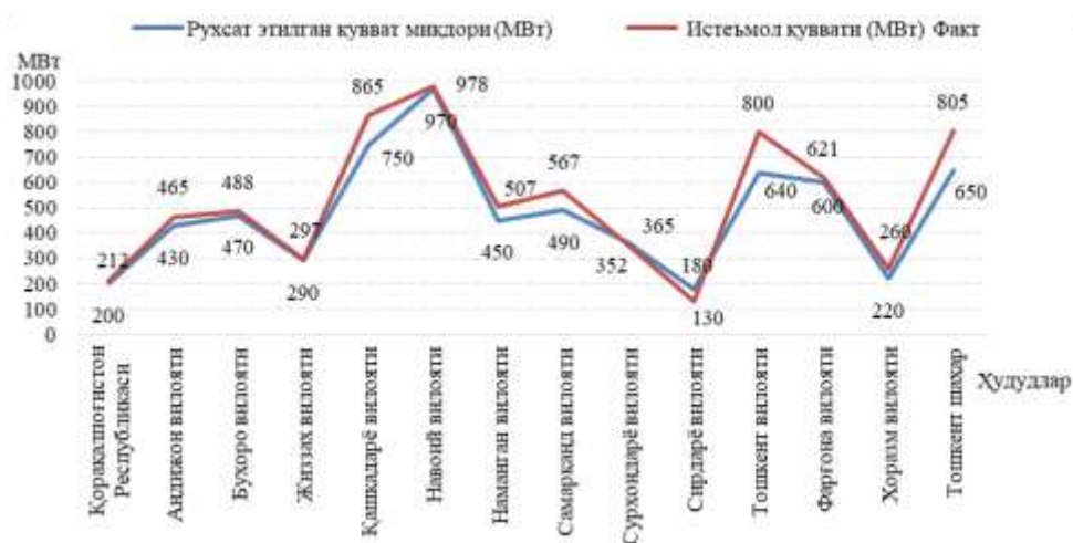
2-расм. Худудларнинг сутканинг “эрталабки” тиғиз даврида рухсат этилган ва истеъмол қилган электр энергиясининг юклама графиги
