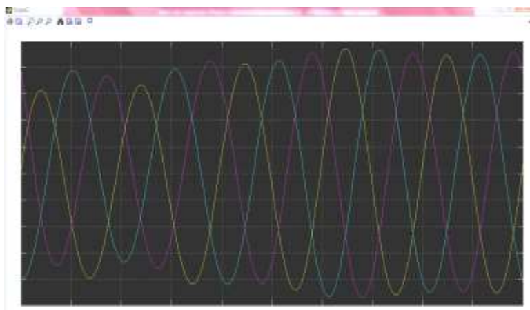
5–расм. Сезиш элементларининг чиқиш кучланишларини вақт бўйича ўзгариш графиклари
