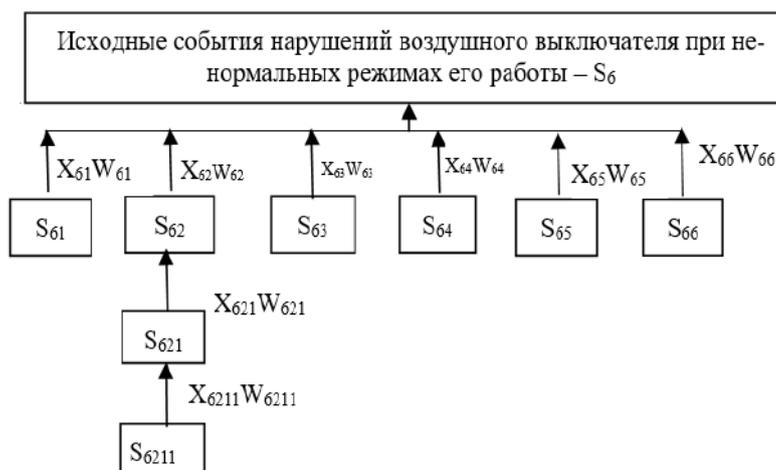
Рис.7. Исходные события нарушений воздушного выключателя при ненормальных режимах его работы:  $S_{61}$  - поломка изоляторов;  $S_{62}$  - разрушение дугогасительного устройства;  $S_{621}$  - из-за непогашения дуги;  $S_{6211}$  - короткого замыкания;  $S_{63}$  - отказ привода и цепей управления;  $S_{64}$  - перекрытие опорных изоляторов и воздуходувных труб;  $S_{65}$  - повреждение контактных систем;  $S_{66}$  - дефекты резиновых уплотнений
