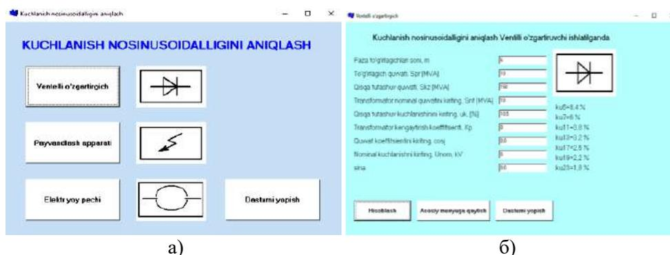
Рис. 2. Главное меню (а) и процесс работы (б) программы определения коэффициентов несинусоидальности напряжения, создаваемой электроустановками
