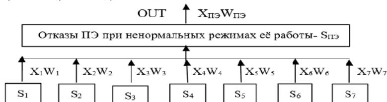
Рис.1. Отказы ПЭ при ненормальных режимах её работы:  $S_1$  - масляного трансформатора;  $S_2$  - трансформатора тока;  $S_3$  - трансформатора напряжения;  $S_4$  - линии электропередачи;  $S_5$  - масляного выключателя;  $S_6$  - воздушного выключателя;  $S_7$  – разъединителя
