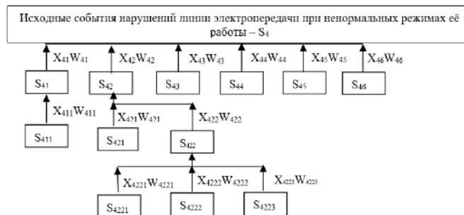
Рис.5. Исходные события нарушений линии электропередачи при ненормальных режимах её работы:  $S_{41}$  - повреждение опор;  $S_{411}$  - из-за гололедно-ветровых нагрузок;  $S_{42}$  - повреждение проводов;  $S_{421}$  - нарушение механической прочности проводов;  $S_{422}$  - одно- и многофазные короткие замыкания;  $S_{4221}$  -
