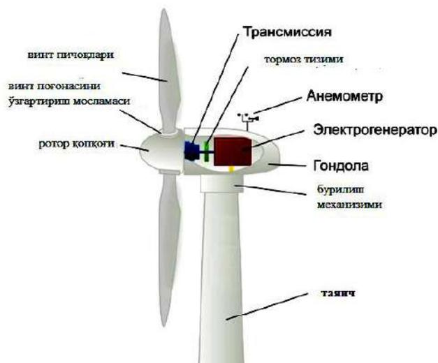
5-расм. Шамол турбинаси схемаси [7]
