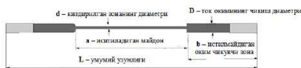
К-типидаги хромит лантан электронагреватели гантел шаклда бўлиб, а-ишчи соҳаси, L-умумий узунлиги, d-ишчи қисмининг диаметри, D-контакт қисмининг диаметри, b-совуқ контакт қисми, K – типидagi электронагревателларнинг максимал иш ҳарорати  $1750^{\circ}\text{C}$  ни ташкил этади. [7].
