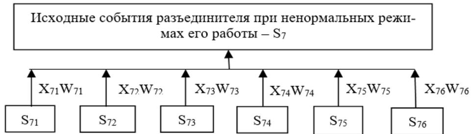
Рис.8. Исходные события разъединителя при ненормальных режимах его работы:  $S_{71}$  - обледенение или разрегулировка;  $S_{72}$  - пробой или повреждение изоляции;  $S_{73}$  - отказ привода;  $S_{74}$  - неисправность механизма;  $S_{75}$  - дефекты контактных соединений;  $S_{76}$  - ошибка персонала
