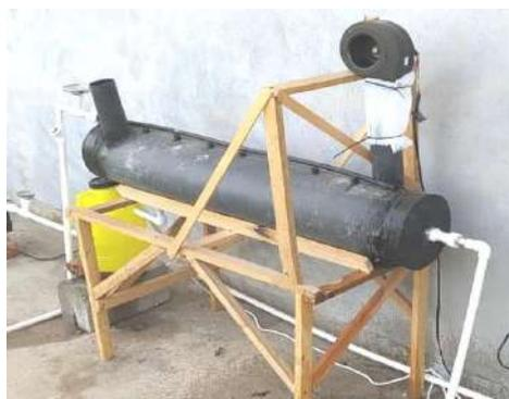
Рис.2. Опытно-экспериментальная установка косвенно испарительного охлаждения оборотной воды (испарительная камера)
