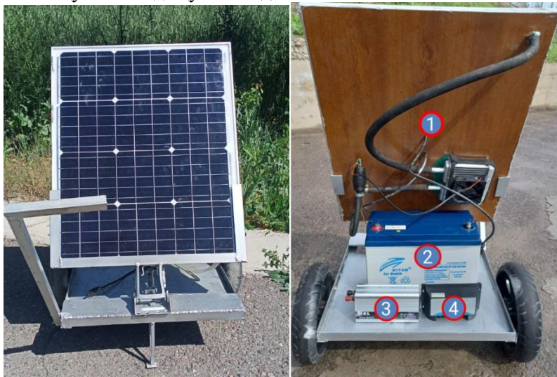
1-расм ФИБ ли қурилманинг олд томондан кўриниши, 2.б) расм ФИБ ли қурилманинг орқа томондан кўриниши. 1-б қуёш панели, 2-б аккумулятор, 3-б инвертор, 4-б контроллер
