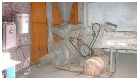
1-расм. Универсал ем майдалаш қурилмасининг асинхрон моторини частота ўзгартгич орқали бошқариш
