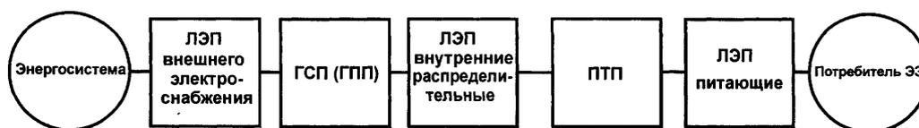
Рис. 1. Блок-схема системы электроснабжения промышленных предприятий
